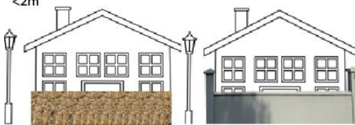
Mur plein en pierres
