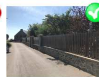
Clôture >2m avec lisses PVC très peu ajourées, verticales et végétation en haut + petit mur plein en pierres en bas.
