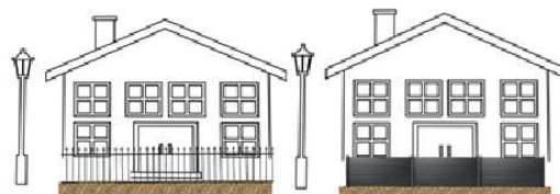
Grandes ferronneries ajourées en haut + Petit mur plein en bas
